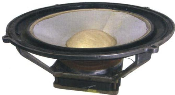
Fig. 5 Lack: Bellissima la membrana composta di questo woofer Lack anni sessanta: polistirolo con una sottile lamina in alluminio.
