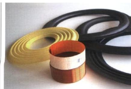
Fig. 8 VoiceCoil: Bobina mobile di un midwoofer, avvolta su supporto in Kapton, assieme al relativo spider e surround in gomma, foam e tela trattata.
