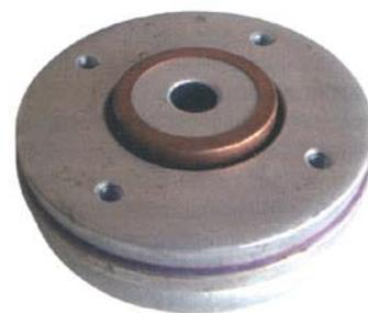
Fig. 7 Mag2: un gruppo magnetico per woofer in neodimio. Si notino le compatte dimensioni e l'anello in rame sul polo centrale, che linearizza l'andamento dell'impedenza della bobina mobile.
