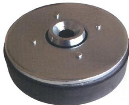
Fig. 6 Mag1: un tradizionale gruppo magnetico per woofer in ferrite: si noti il polo centrale rialzato, un espediente che permette di ottenere un campo maggiormente simmetrico.
