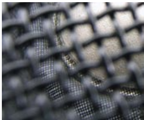
7 Fig. 7 Dettaglio della cupola del tweeter delle NX-6A, attraverso la retina di protezione. La membrana utilizza un materiale rigido con riporto di ceramica, ed una sospensione in tela trattata ne ottimizza lo smorzamento e le risonanze.
