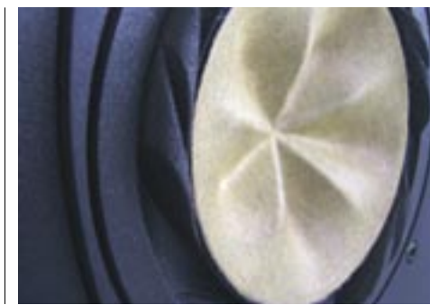
Fig. 5 Un dettaglio del bellissimo cono delle NF-01A: la particolare sezione minimizza i modi di risonanza della membrana, e la sospensione dal profilo intagliato ottimizza la linearità dinamica dell'escursione.
