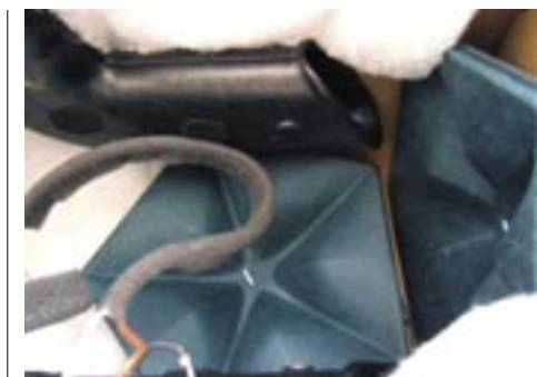
Fig. 4 L'interno dei diffusori è ordinato e nasconde alcune chicche molto interessanti: i pannelli in fibra di cellulosa pentagonali effettuano uno smorzamento delle riflessioni interne al mobile.
